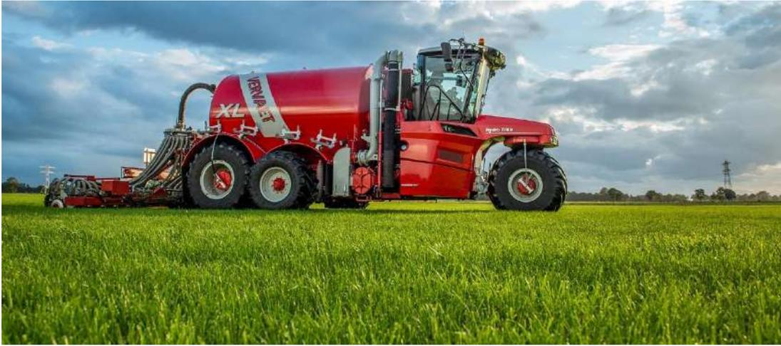
**Figure 3 - Automoteur avec disques enfouisseurs**
