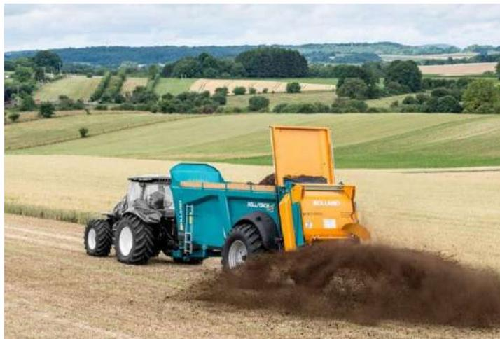
**Figure 4 - Epandage de digestat solide à l'aide d'un épandeur à fumier**
